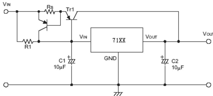
4、 提高输出电压电路(1)
